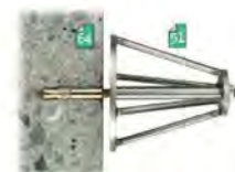
Goujon d'ancrage taraudé Convient pour des façades en béton et en roche dure. Lors de l'introduction par vissage de la tige filetée, le goujon s'écarte et se fixe solidement.
