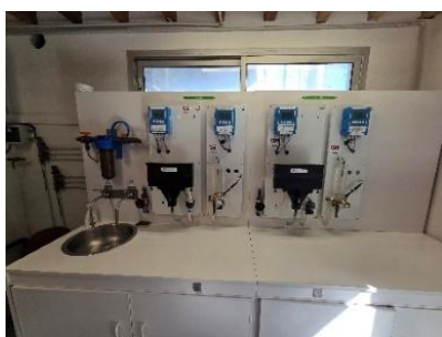
Figure 3 : banc de tests et mesures pour le suivi de la qualité d'eau (Photo CE)
